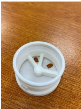
Ilustración 32 rediseño de tapa impresa parte superior
