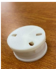
Ilustración 32 rediseño de tapa impresa parte superior
